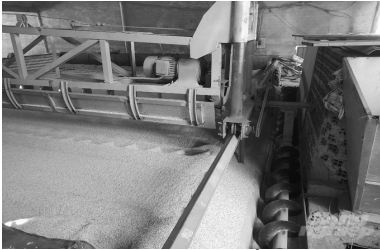
Máy trang lúa của ông Trần Văn Chung thực hiện 3 chức năng trang, sấy và gom lúa, giúp tiết kiệm từ 1,2 - 1,3 triệu đồng/mẻ sấy.
